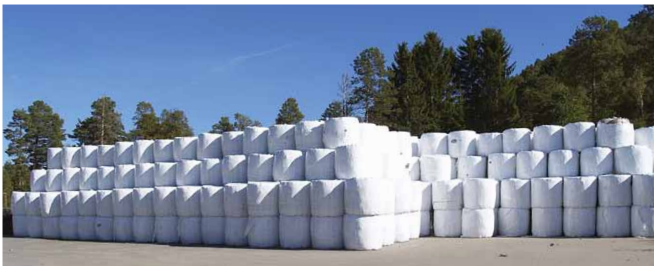
Baller med restavfall blir lagret i sommerhalvåret i påvente av kaldere vær og større behov for brensel hos fjernvarmeanleggene.
