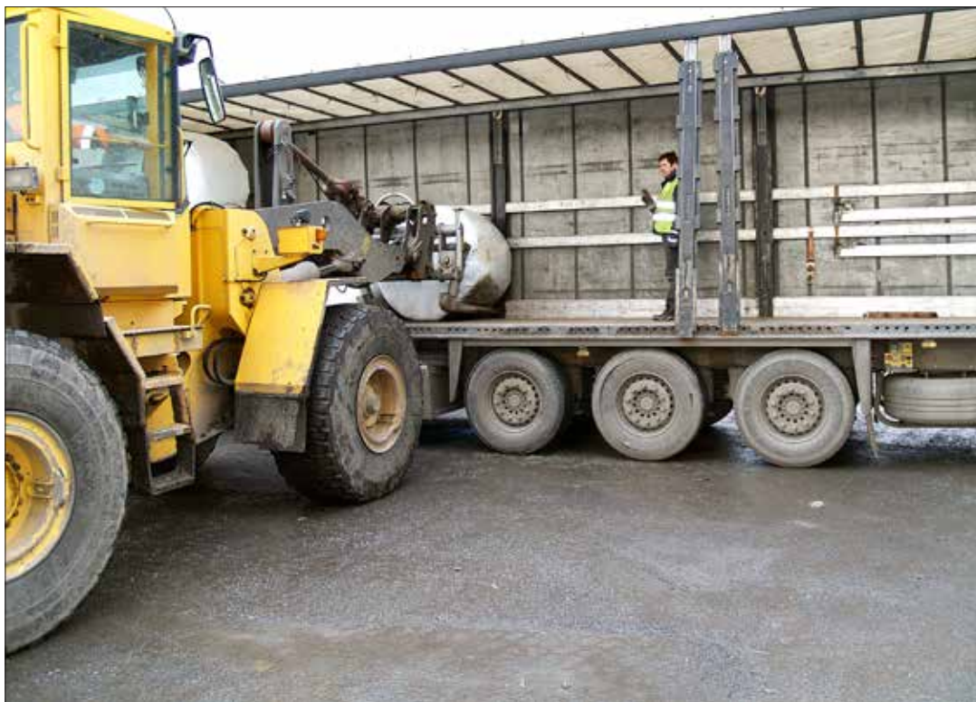
Pakking av restavfall i baller gjør transporten til forbrenningsanlegg lettere.
